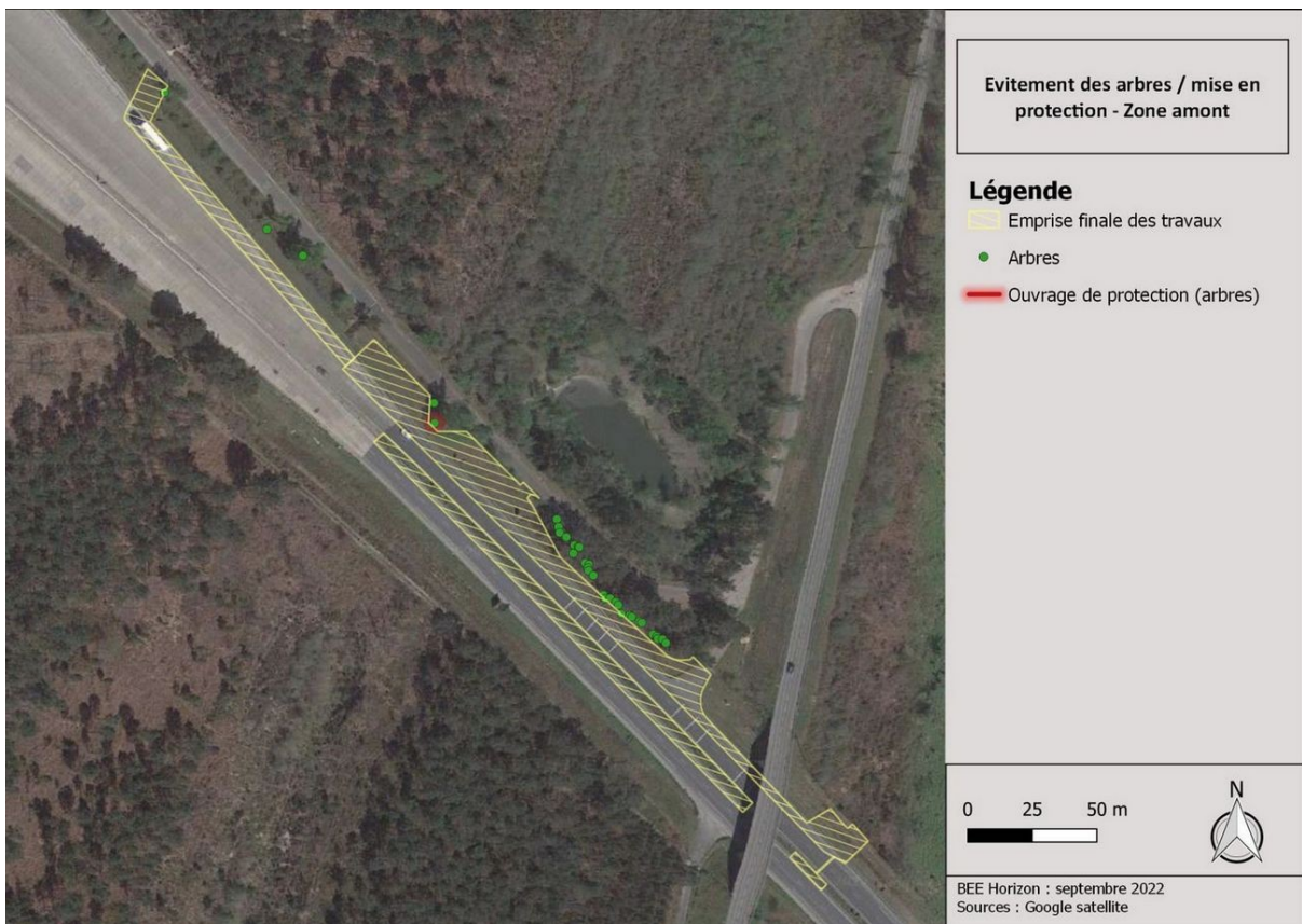
Figure 1 : de haut en bas, à chaque fois pour le secteur aval et le secteur amont, localisation des secteurs évités, positionnement des barrières de protection dans les secteurs non pourvus de glissières de sécurité, localisation des protections d'arbre
